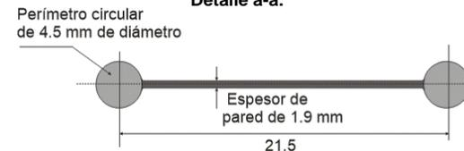
Espécimen de ensayo: Tipo I moldeado con el compuesto plástico que se solicita en la producción de la asa.
